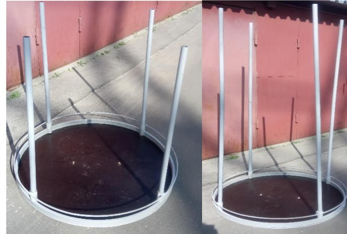
6. В подставку опорную устанавливаем стойки нижние, в них стойки верхние.
