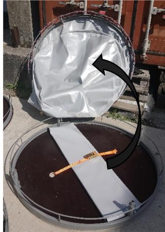
3. Поднимаем верхний пенал и откладываем в сторону. Вынимаем из подставки опорной закладные втулки
