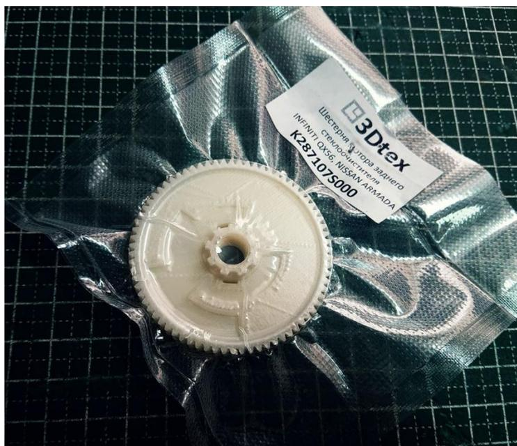
Шестерня для мотора заднего стеклоочистителя Infiniti QX56, Nissan Armada
