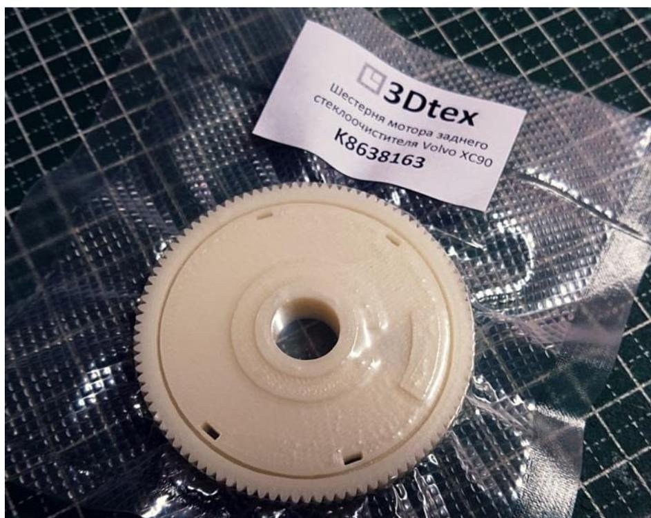
Шестерня для мотора заднего стеклоочистителя Volvo XC 90 K8638163
