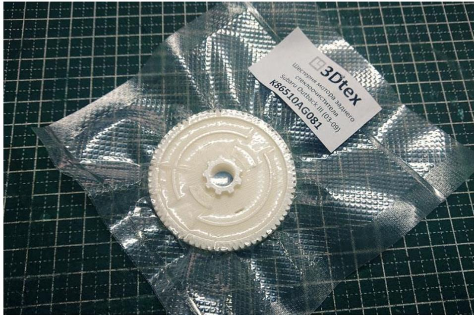
Шестерня для мотора заднего стеклоочистителя Subaru Outback III (03-09 г.в.)
