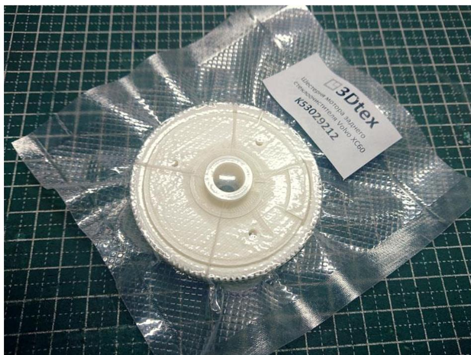
Шестерня для мотора заднего стеклоочистителя Volvo XC60
