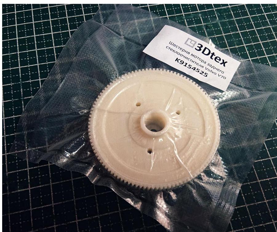
Шестерня для мотора заднего стеклоочистителя Volvo V70
