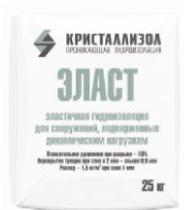
**КРИСТАЛЛИЗОЛ ЭЛАСТ** (ГОСТ 31357-2007; ТУ 5745-001-38213907-11) – однокомпонентная обмазочная гидроизоляция для всех типов поверхностей. При толщине слоя в 2мм имеет удлинение при разрыве около 10%. Время готовности гидроизоляционного покрытия составляет 3 суток.
