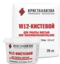
**КРИСТАЛЛИЗОЛ W12 – КИСТЕВОЙ** (ГОСТ 31357-2007; ТУ 5745-001-99001832-07) - для внутренней и наружной гидроизоляции по новым бетонным поверхностям в подземных и заглубленных сооружениях, работающих в условиях постоянного или переменного воздействия водной среды, при отсутствии фильтрации грунтовых вод на момент проведения работ. Наносится кистью. Не используется для работ по кирпичу.
