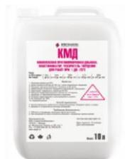
**КРИСТАЛЛИЗОЛ КМД** (ТУ 5745-002-38213907-2011) – комплексная морозостойкая добавка-пластификатор для изготовления растворов и бетонных смесей при температуре до -25°С. Увеличивает пластичность до П4-П5, повышает прочность бетона до 50% и более в возрасте 1 суток нормального твердения. Снижает расход воды затворения на 6-11% и более.
