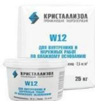
**КРИСТАЛЛИЗОЛ W12** (ГОСТ 31357-2007; ТУ 5745-001-99001832-07) - для внутренней и наружной гидроизоляции бетонных, каменных и кирпичных конструкций в подземных и заглубленных сооружениях, работающих в условиях постоянного или переменного воздействия водной среды, при сильной фильтрации. Наносится шпателем.
