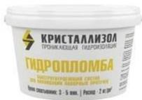
**КРИСТАЛЛИЗОЛ ГИДРОПЛОМБА** (ГОСТ 31357-2007; ТУ 5745-001-99001832-07) - быстротвердеющий состав для ликвидации локальных, напорных течей через трещины, швы, технологические отверстия в конструкциях. Время схватывания от 30 секунд до 3 минут.
