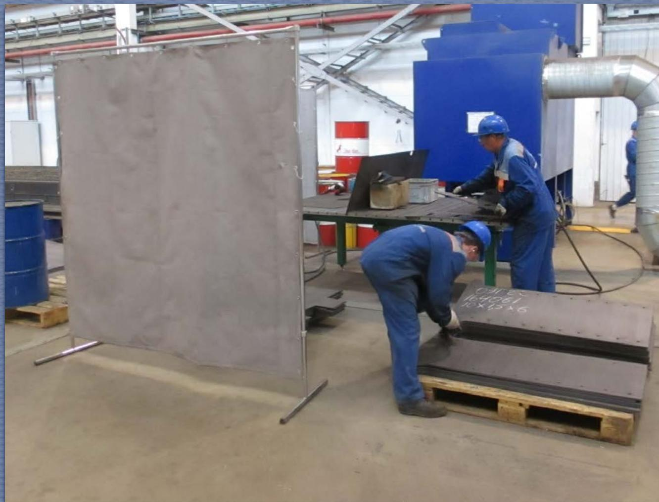
Защитные сварочные экраны
